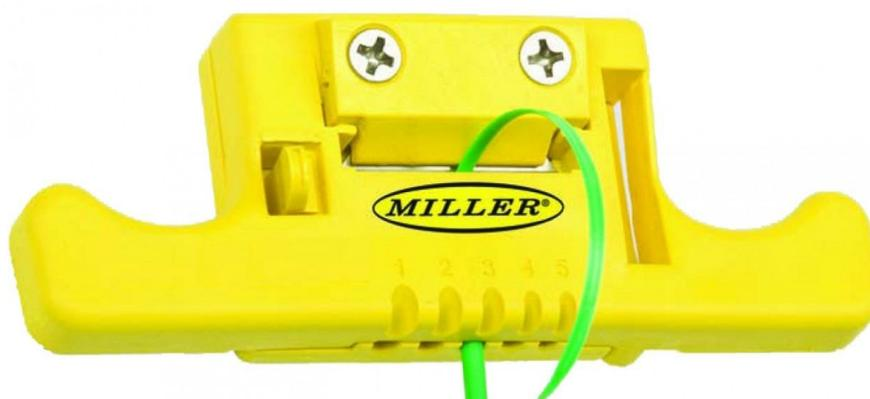
Рис. 3. Разделка ВОК с помощью специального инструмента:
